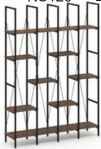
NS142 Librero de 4 entrepaños en mdf 15 mm., estructura metálica, tubular cuadrado de 3/4" y cruceta en redondo de 1/4".
