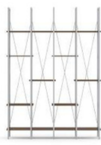
NS180 Librero de 4 entrepaños en mdf 15 mm., estructura metálica, tubular cuadrado de 3/4" y cruceta en redondo de 1/4".
