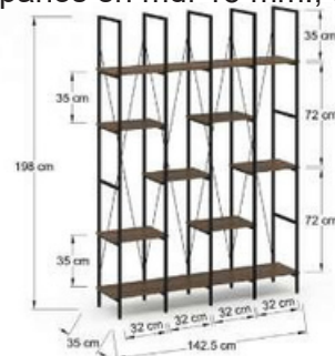
NS142 Librero de 4 entrepaños en mdf 15 mm., estructura metálica, tubular cuadrado de 3/4" y cruceta en redondo de 1/4".
