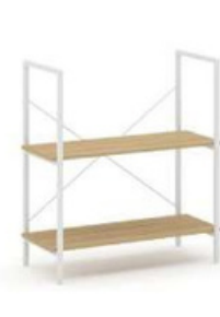
NS180 Librero de 4 entrepaños en mdf 15 mm., estructura metálica, tubular cuadrado de 3/4" y cruceta en redondo de 1/4".
