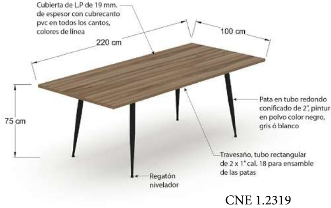
Mesa de juntas soporte conificado de 220x100x75 cm, soportes metalicos fabricados en tubo redondo de 2 pulgadas calibre 16 con reduccion a 3/4 de pulgada de forma conica, cubierta en l.p. de 19mm
